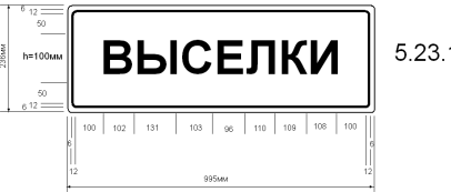
Эскиз дорожного знака 5.23.1 и 5.24.1 с расчетом размеров, исходя из требований ГОСТа Р 52289-2004г.
