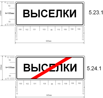
Эскиз дорожного знака 5.23.1 и 5.24.1 с расчетом размеров, исходя из требований ГОСТа Р 52290-2004.
