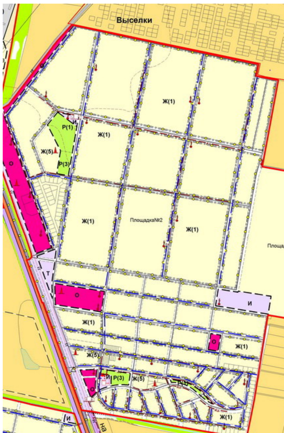
Рисунок 3.4.6.1 - Расположение перспективных объектов системы водоотведения на площадке №2
